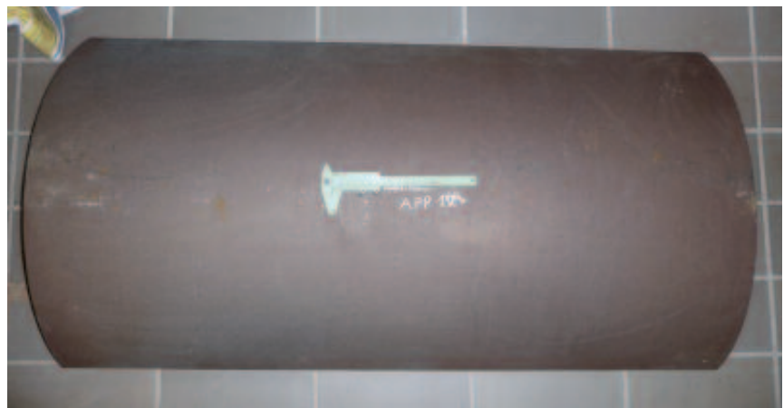
Abb. 4 Metallisch blank gesandstrahlte Rohraußenseite; kein signifikanter Korrosionsangriff erkennbar
